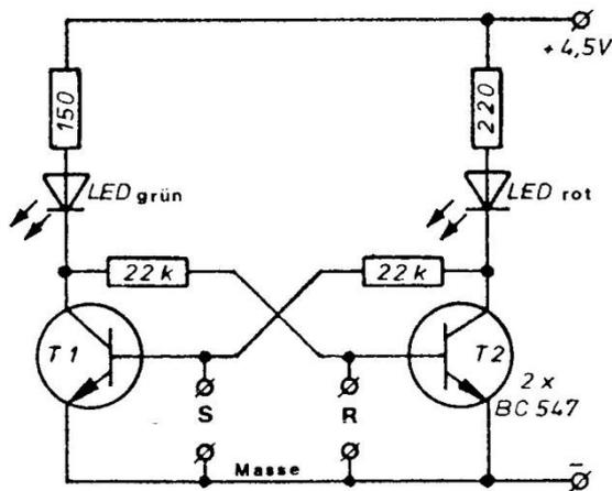
Der Transistor: Ein Transistor hat drei Anschlüsse. Erst wenn an der Basis B eine Spannung anliegt, kann zwischen den beiden anderen Anschlüssen Strom fließen.
